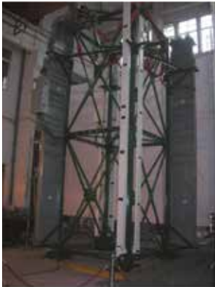
Вертикальные испытания на сейсмическую стойкость
